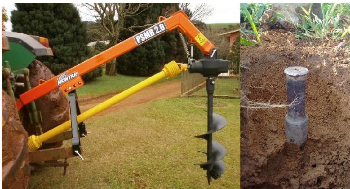
Figura 3: Equipamento de perfuração e coletor de amostras indeformadas.
